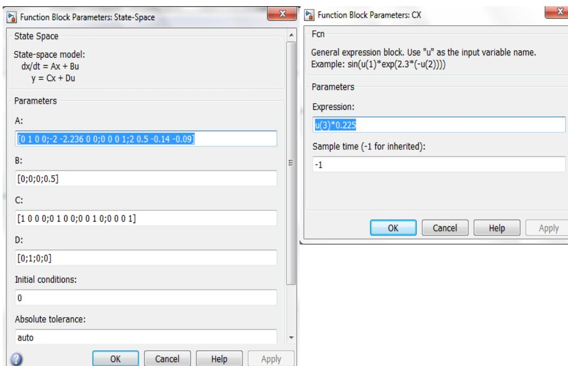
Рисунок 3.13 – Настройка параметров блоков "State-Space" и "f(u)"
