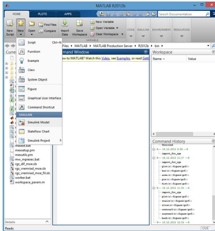
Рисунок 3.25 – Процесс создания новой модели в Simulink
