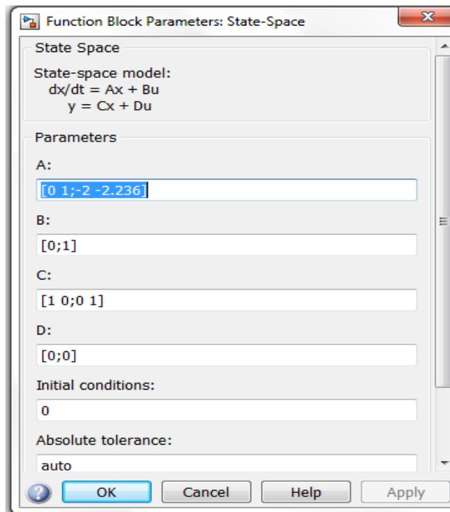
Рисунок 3.8 – Настройка параметров блока "State-Space"
