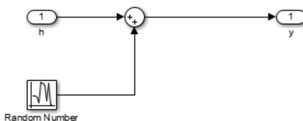
Рисунок 3.11 – Модель датчика (Sensor)
