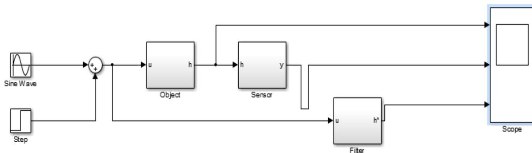
Рисунок 3.6 – Схема верхнего уровня системы контроля
