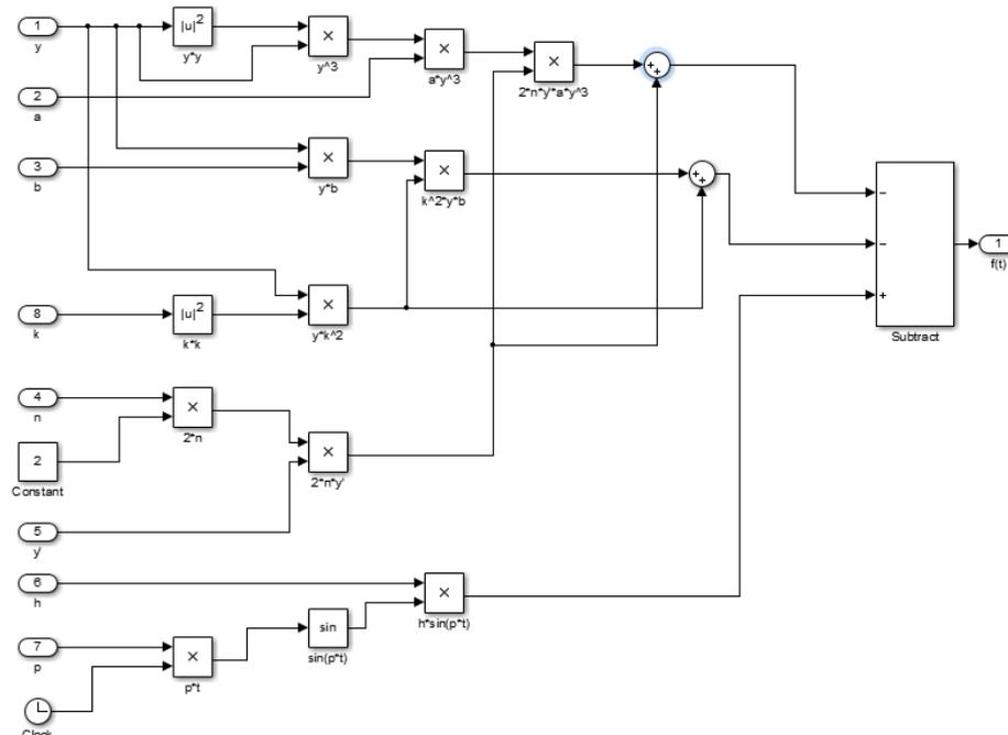
Рисунок 3.20 – Подмодель нелинейного осциллятора
