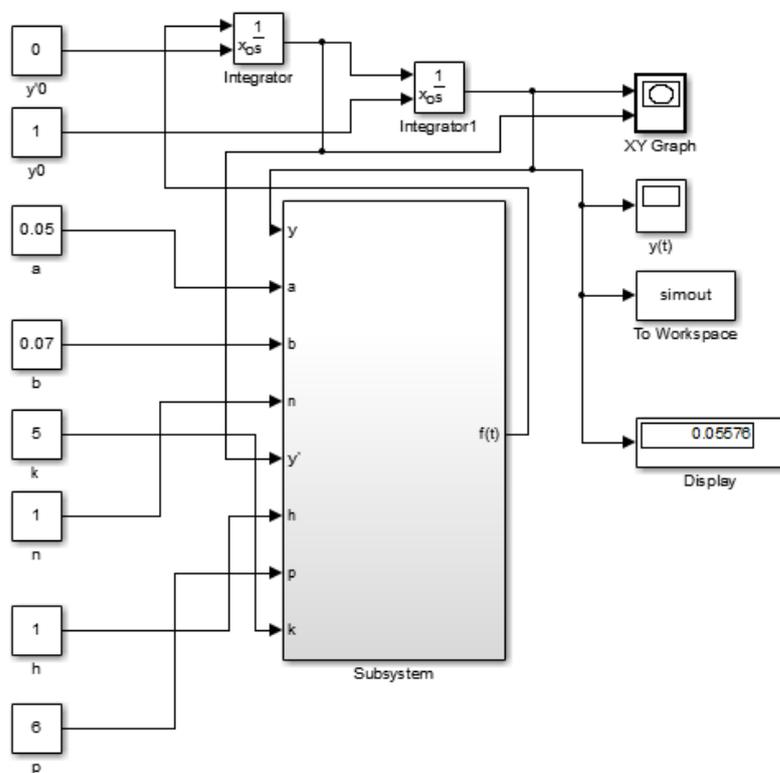
Рисунок 3.21– Основная модель нелинейного осциллятора
