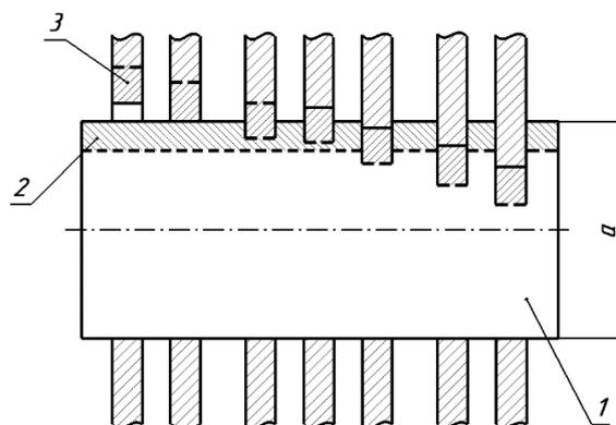
1 – основной вал; 2 – интервал допуска основного вала; 3 – интервал допуска различных отверстий; а – номинальный размер; сплошные горизонтальные линии, ограничивающие интервалы допусков, показывают основные отклонения основного вала и различных отверстий; штриховые линии, ограничивающие интервалы допуска, показывают другие (не основные) предельные отклонения
