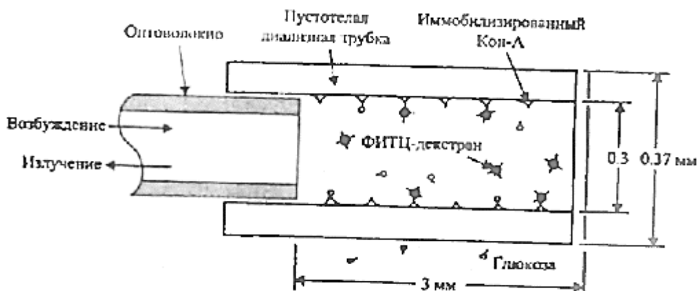
Рисунок 40 - Аффинный датчик измеряет концентрацию глюкозы путем детектирования изменений интенсивности света флуоресценции, вызванных конкурентным связыванием меченого флуоресценции индикатора ФИТЦ (флуоресцеинизотиоцианат), Кон—А (конканавалин).
