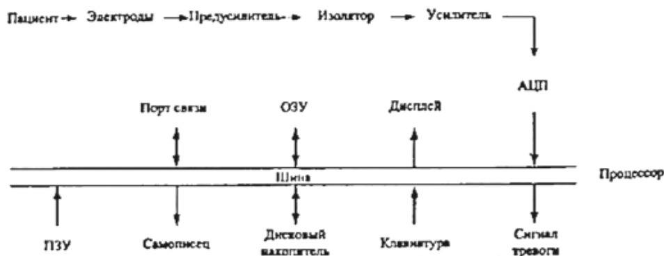
Рисунок 48 – Блок-схема кардиомонитора: АЦП – аналого-цифровой преобразователь; ОЗУ — оперативное запоминающее устройство; ПЗУ – постоянное запоминающее устройство
