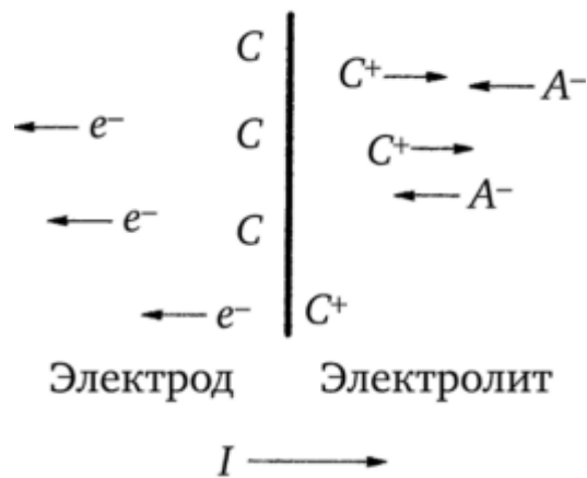
Рисунок 18 – Граница раздела между электродом и электролитом. Ток пересекает ее слева направо. Электрод состоит из металлических атомов C . Электролит – это жидкий раствор, содержащий катионы электродного металла C^+ и анионы A^-
