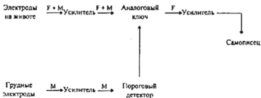
Рисунок 47 – Блок-схема системы для выделения ЭКГ плода из суммарной ЭКГ плода и матери
