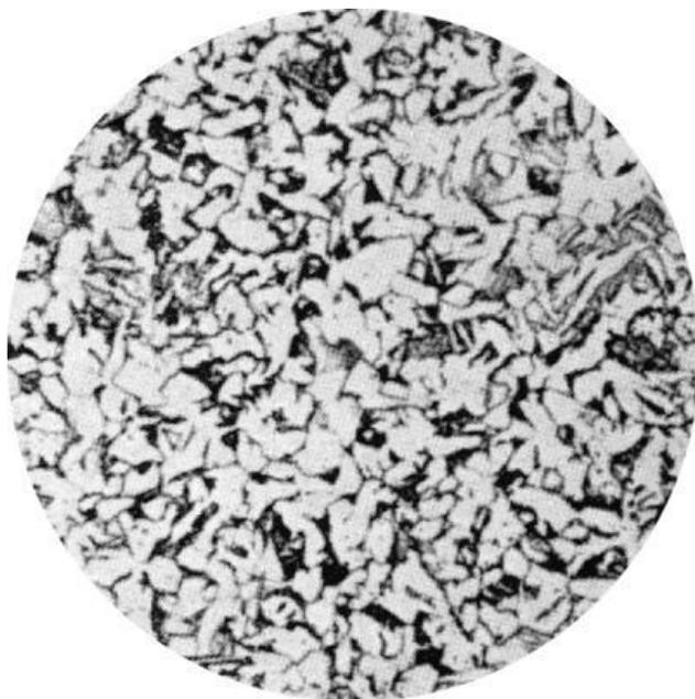
Рисунок 23 – Микроструктура стали X12Ф1 (перед отжигом ковка в интервале температур 850-1100°С), х 500
