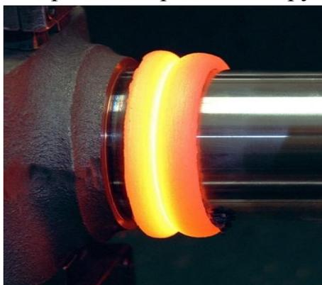
Рисунок 3 – Грат при сварке трением
