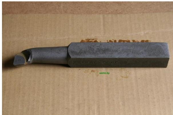
Рисунок 27 – Резец с паяной твердосплавной пластиной
