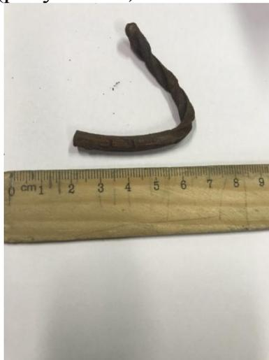
Рисунок 16 – Внешний вид сверла из быстрорежущей стали
