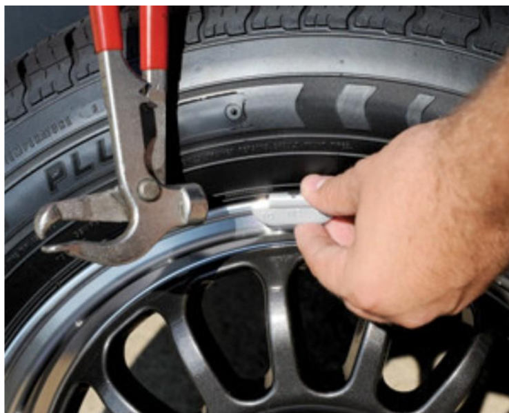
Рисунок 7.20 – Схема установки грузиков
