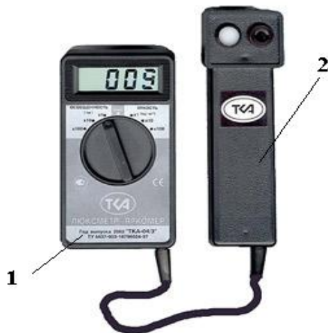
1 – Блок обработки сигналов; 2 – Фотометрическая головка
