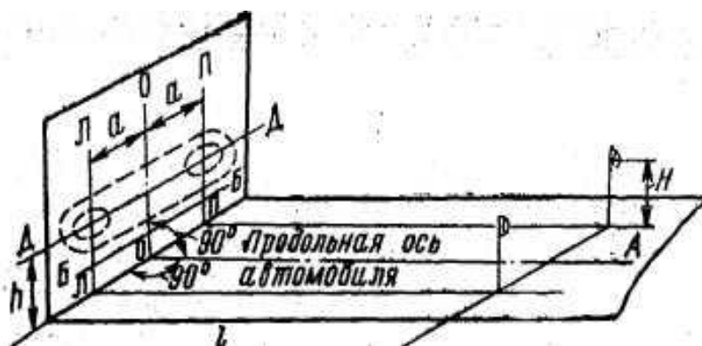
Рисунок 5.6 – Исходные данные для разметки экрана и площадки для регулировки фар с американским светораспределением
