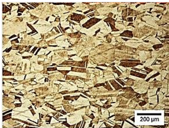
Рисунок А.1 – Микроструктура бронзы с различными формами кристаллитов
