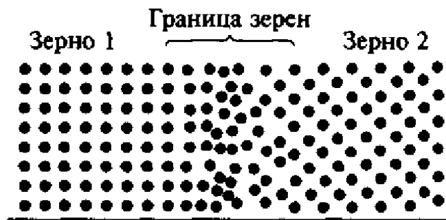
Рисунок 12 – Схема строения зерен и границы между ними
