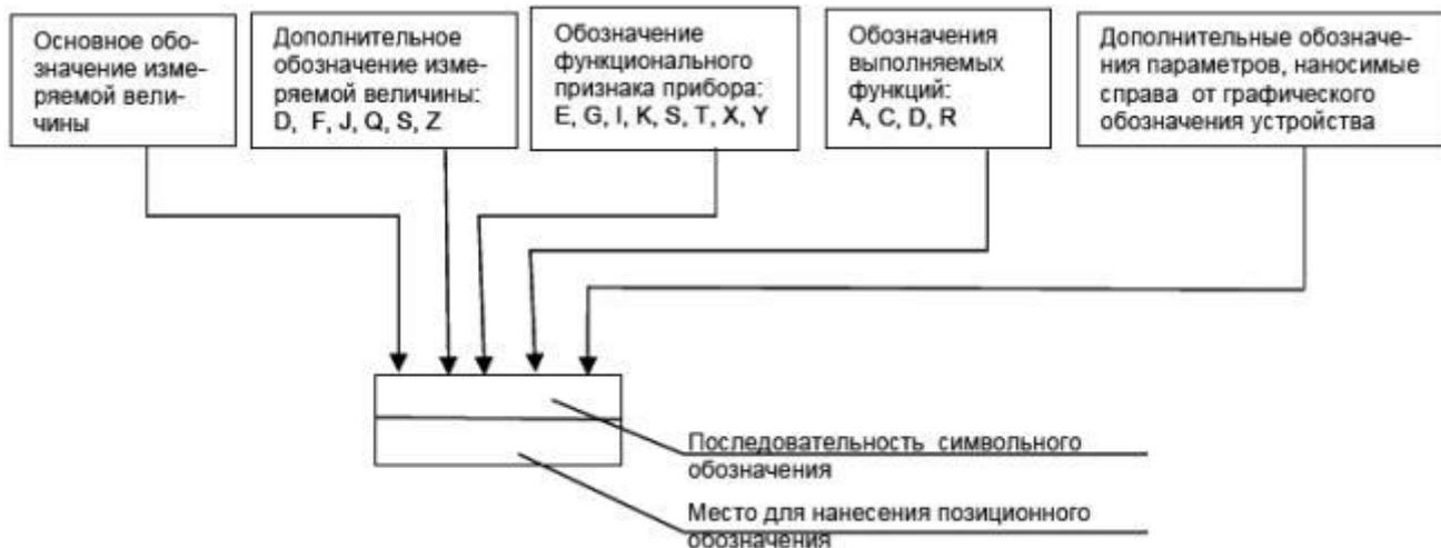
Рисунок 3.6 – Принцип построения условного обозначения прибора
