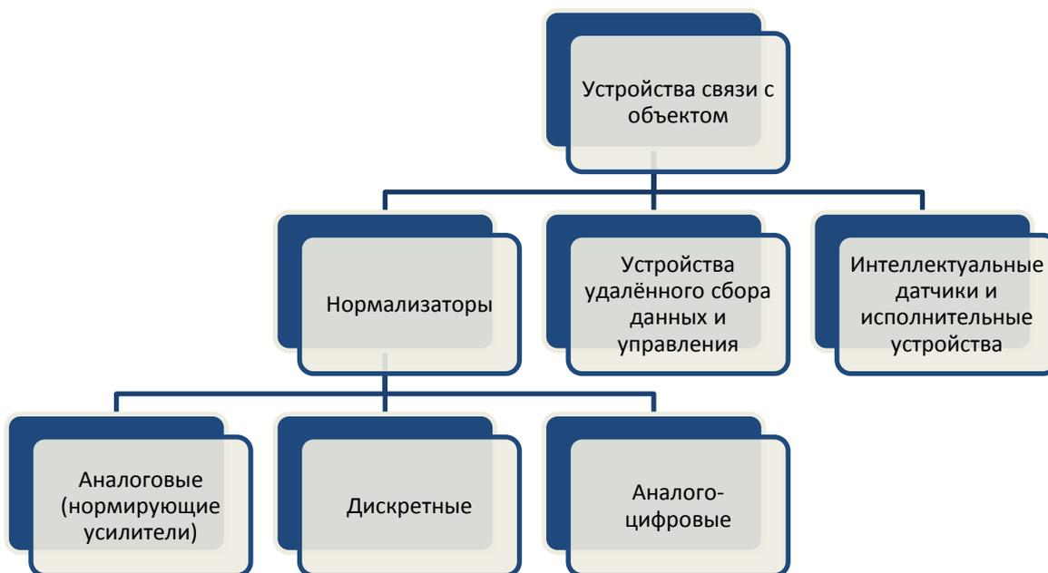
Рисунок 2.1 – Классификация устройств связи с объектом
