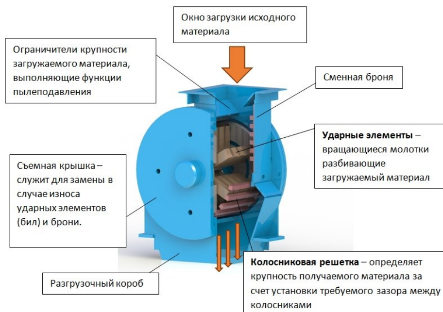
Рисунок 3.2 – Устройство молотковой дробилки МПС-150
