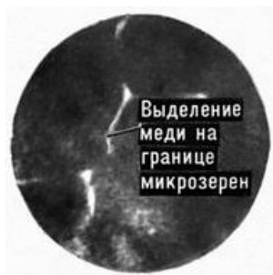
Рисунок 5 – Снимок микроструктуры сплава алюминия и меди, полученный с помощью рентгеновского микроскопа
