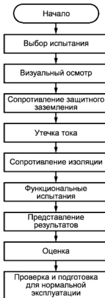
Рисунок Б.1 - Последовательность испытаний
