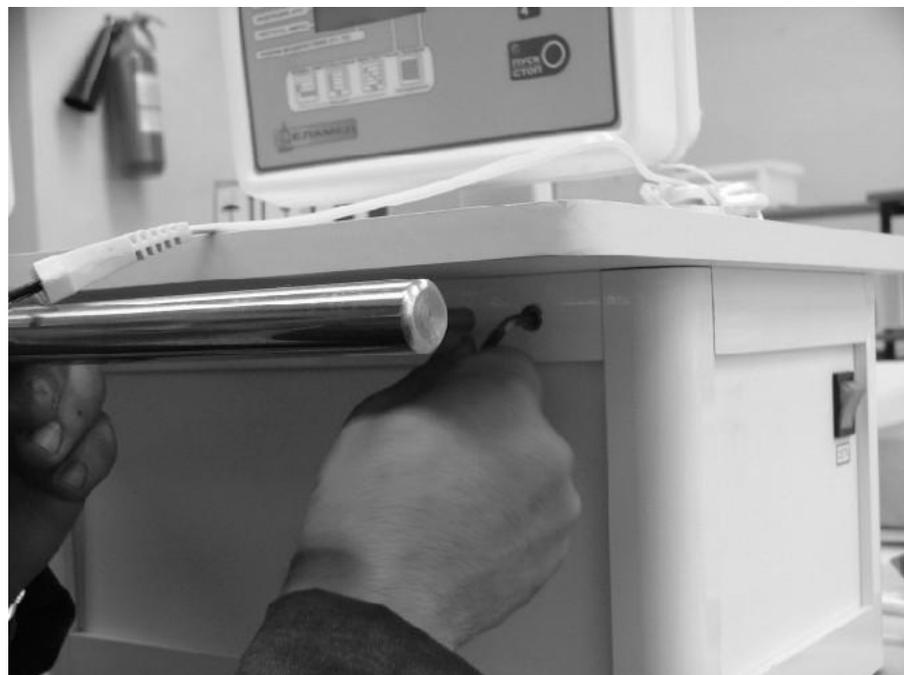
Рисунок 17 - Замки фиксирующие столешницу спереди
