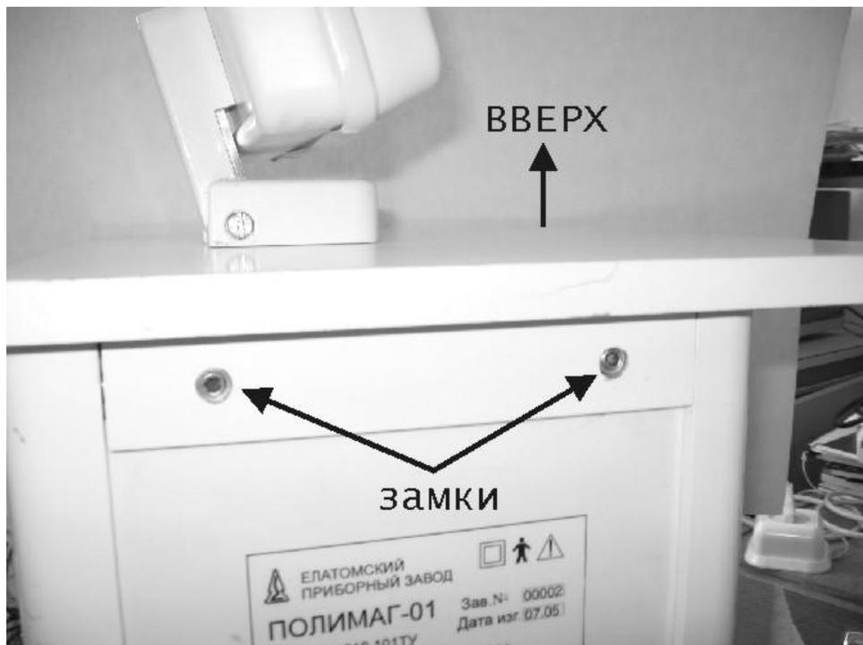
Рисунок 16 - Замки фиксирующие столешницу сбоку
