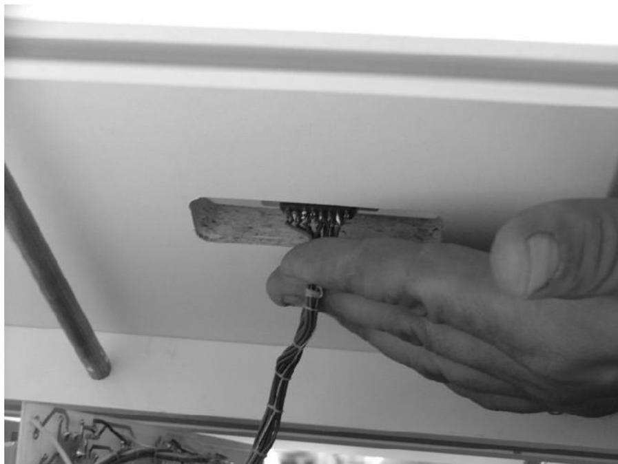
Рисунок 18 - Разъем, соединяющий панель управления и блок питания
