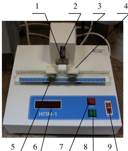
Рисунок 3.11 – Устройство для контроля прочности ИППМ-1: 1– образец экструдированного кормового продукта; 2 – пуансон; 3 – кожух прибора; 4 – опоры для образца; 5 – гайки для регулировки расстояния между опорами; 6 – плата микропроцессора; 7 – выключатель сети; 8 – кнопка «Пуск»; 9 – кнопка «Стоп».
