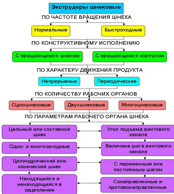
Рисунок 1.3 – Классификация шнековых пресс-экструдеров по данным С.В. Денисова, Т.А. Дидык, В.П. Ханина [36, 37, 143]
