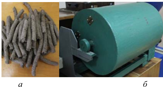
Рисунок 3.10 – Устройство для определения крошимости готовых экструдированных изделий ППГ – 2: а) – экструдат; б) – прибор ППГ – 2
