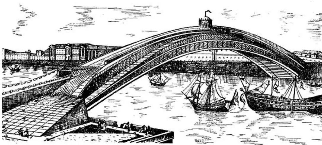
Рисунок 11 – Одноарочный мост по проекту И.П. Кулибина
