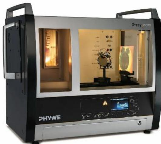
**Рисунок 1. Рентгеновская установка RHYWE X-ray XR 4.0**
