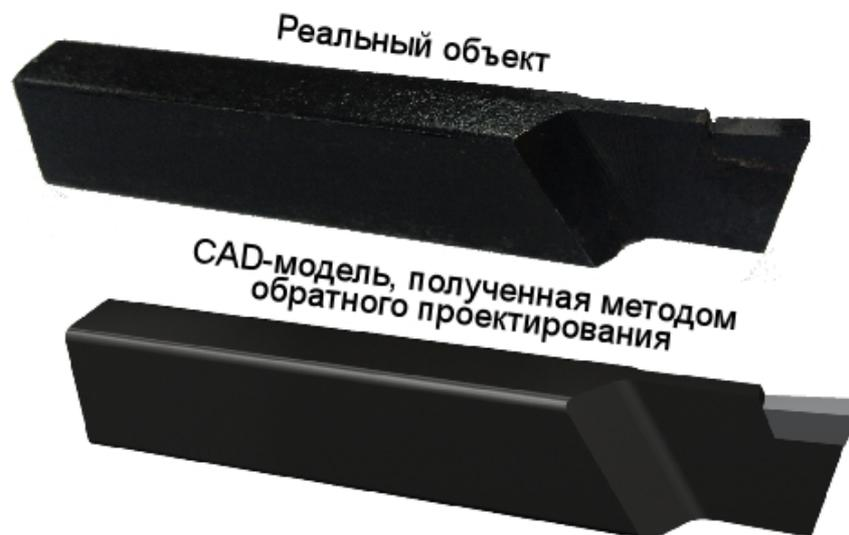
Рисунок 3 – Результат построения CAD-модели резца
