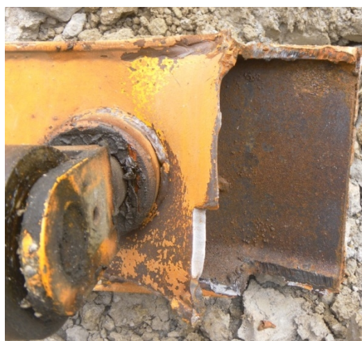
Рисунок 1 – Коррозионное повреждение металлоконструкций башенного крана
