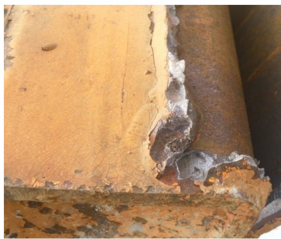
Рисунок 1 – Коррозионное повреждение металлоконструкций башенного крана
