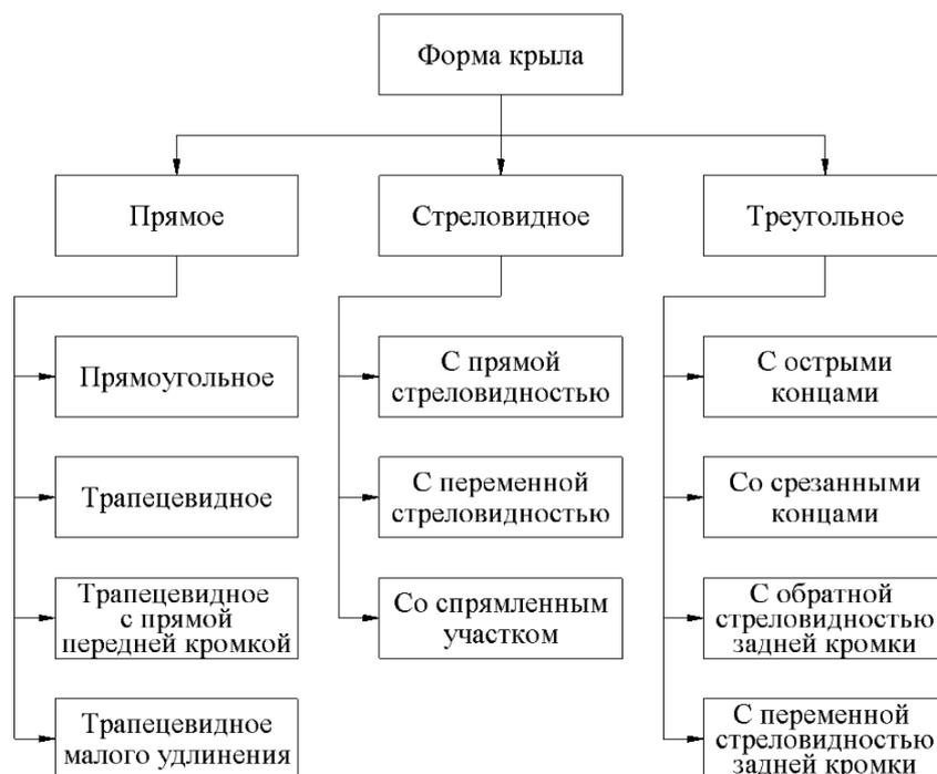
Рисунок 1 – Классификация крыльев по форме в плане
