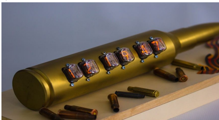
Рисунок 4 – Действующая модель часов на радиолампах
