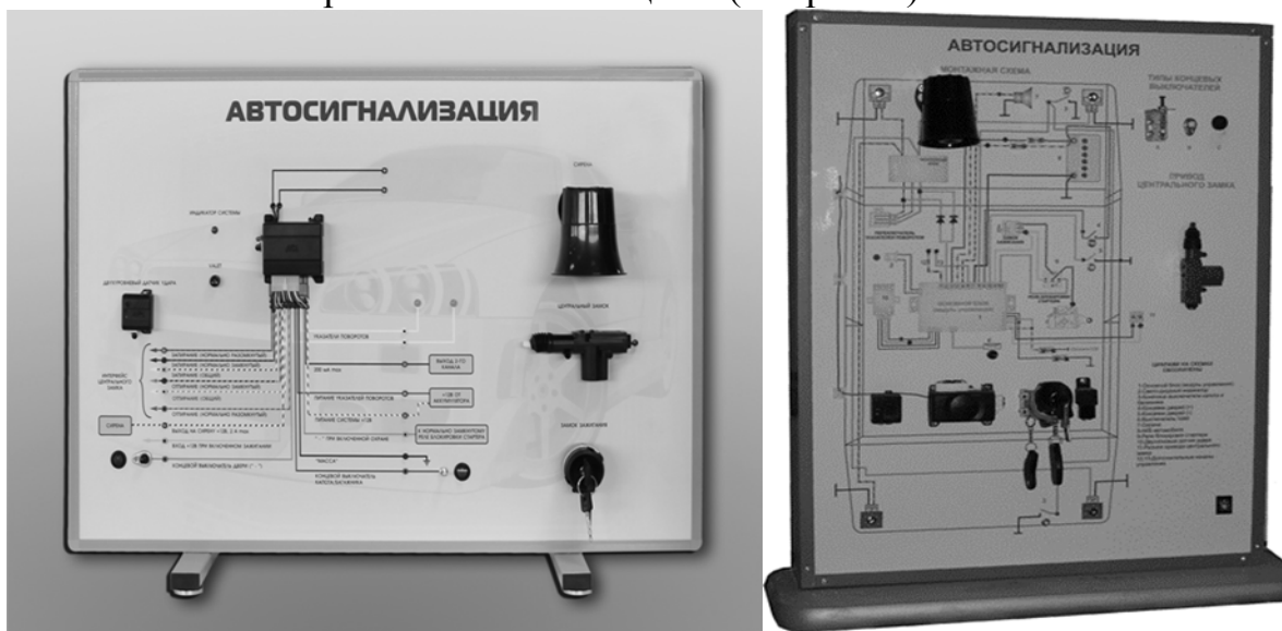
Рис. 1. Лабораторные стенды «Системы автомобильной охранной сигнализации»
