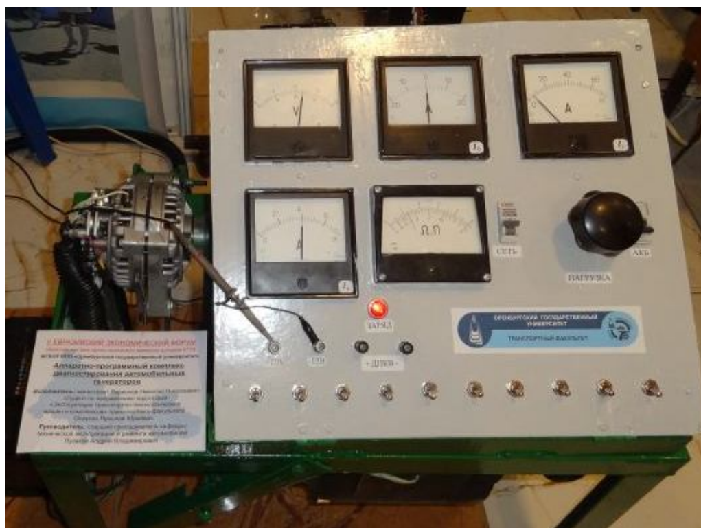
Рис. 5 – Фото аппаратно-программного комплекса диагностирования автомобильных генераторов
