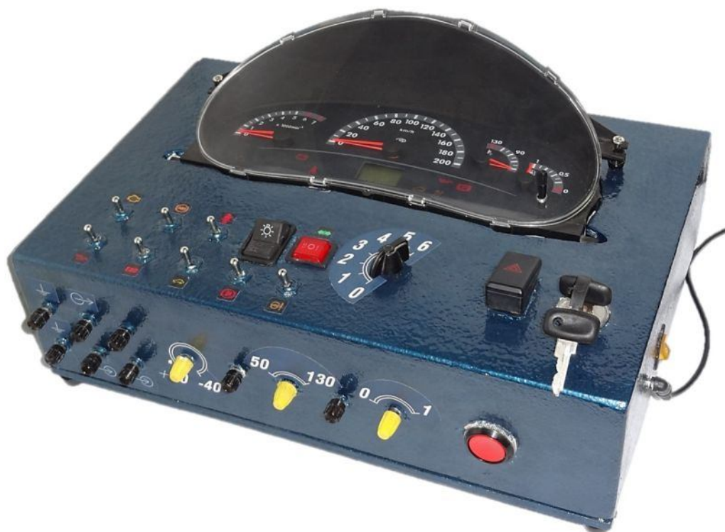
Рис. 1 – Стенд-тренажёр «Информационно-измерительная система автомобиля»
