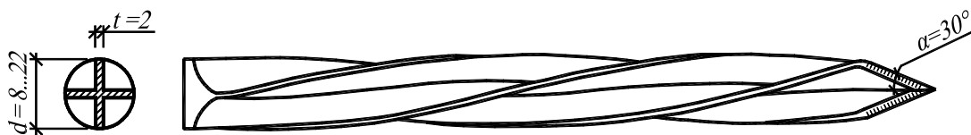
Рисунок 4 - Стальной крестообразный стержень витой формы
