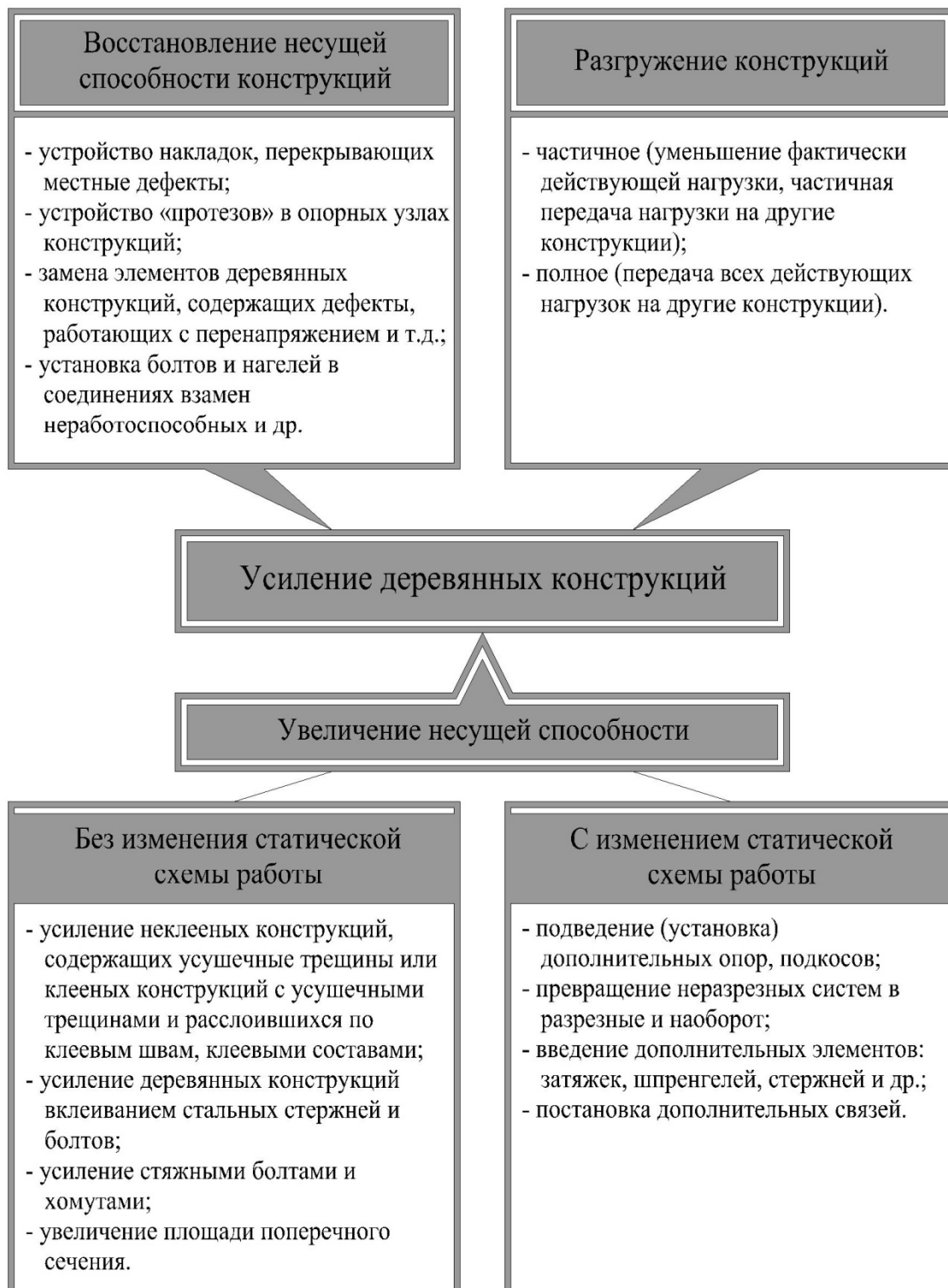
Рисунок 1 - Способы усиления деревянных конструкций
