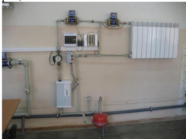
Рисунок 7 – Лабораторный стенд для изучения тепловых характеристик отопительных приборов
