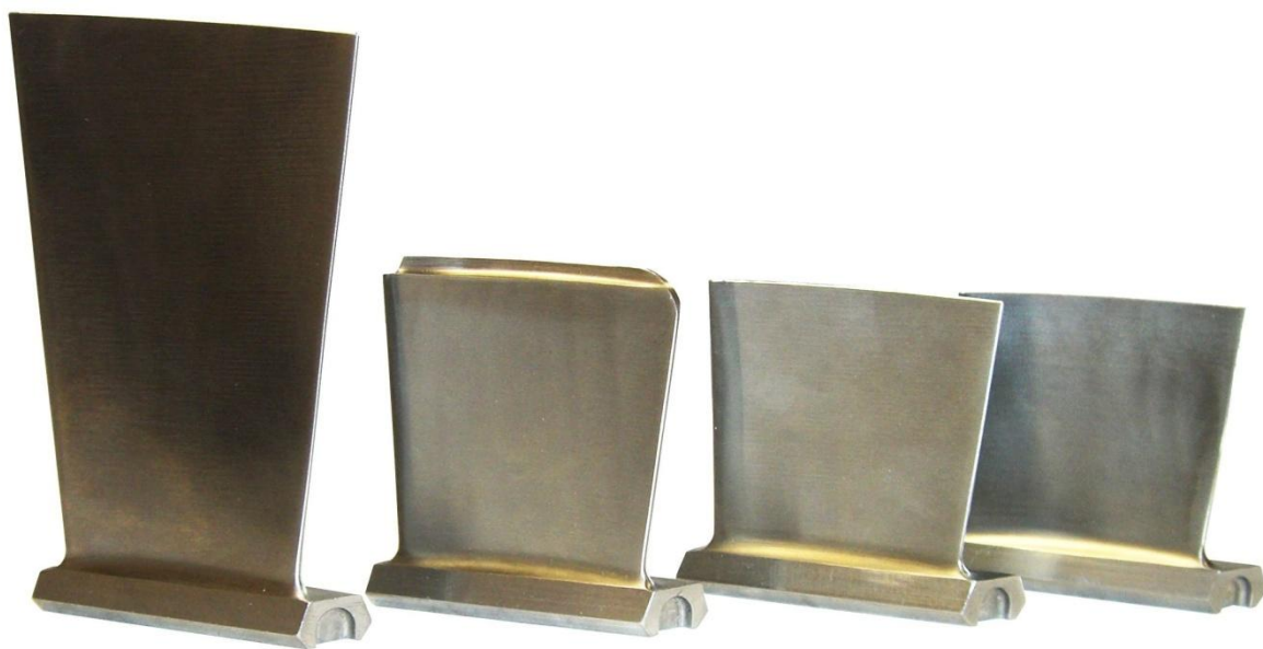
Рисунок 7 – Лопатки компрессора высокого давления из титана.
