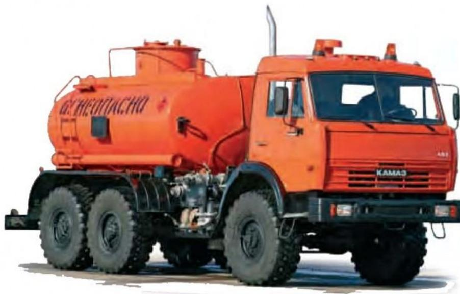
Рисунок – 3 АТЗ 7 на базе шасси КамАЗ 43114.
