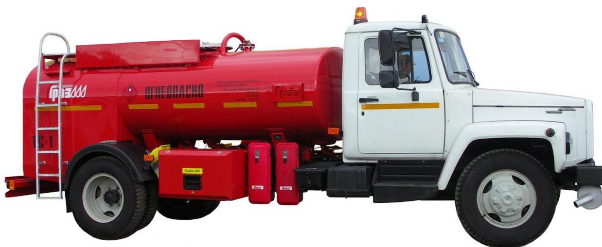
Рисунок-4 ТЗА-4 на базе шасси ГАЗ-53,
