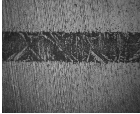
Рисунок 1 – Металлография соединения VT6C+OT4-1 с одной прослойкой титановой фольги, x 200 крат
