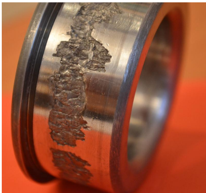
Рисунок 1.16 – Выкрашивание дорожки качения внутреннего кольца подшипника 6-42408К4
