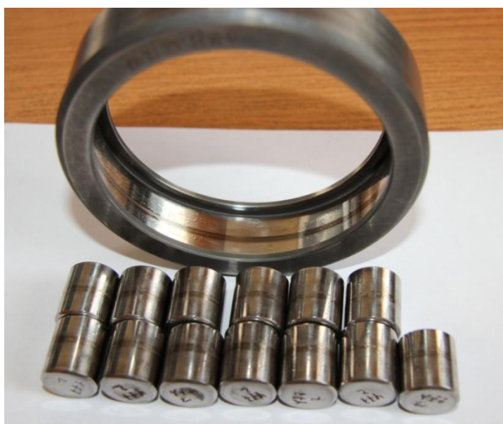
Рисунок 1.17 – Наклеп в виде рисок по центру образующей роликов и дорожки качения наружного кольца подшипника 6-42408К4
