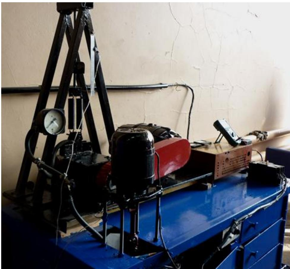
Рисунок 6 - Лабораторная установка для испытания подшипников скольжения
