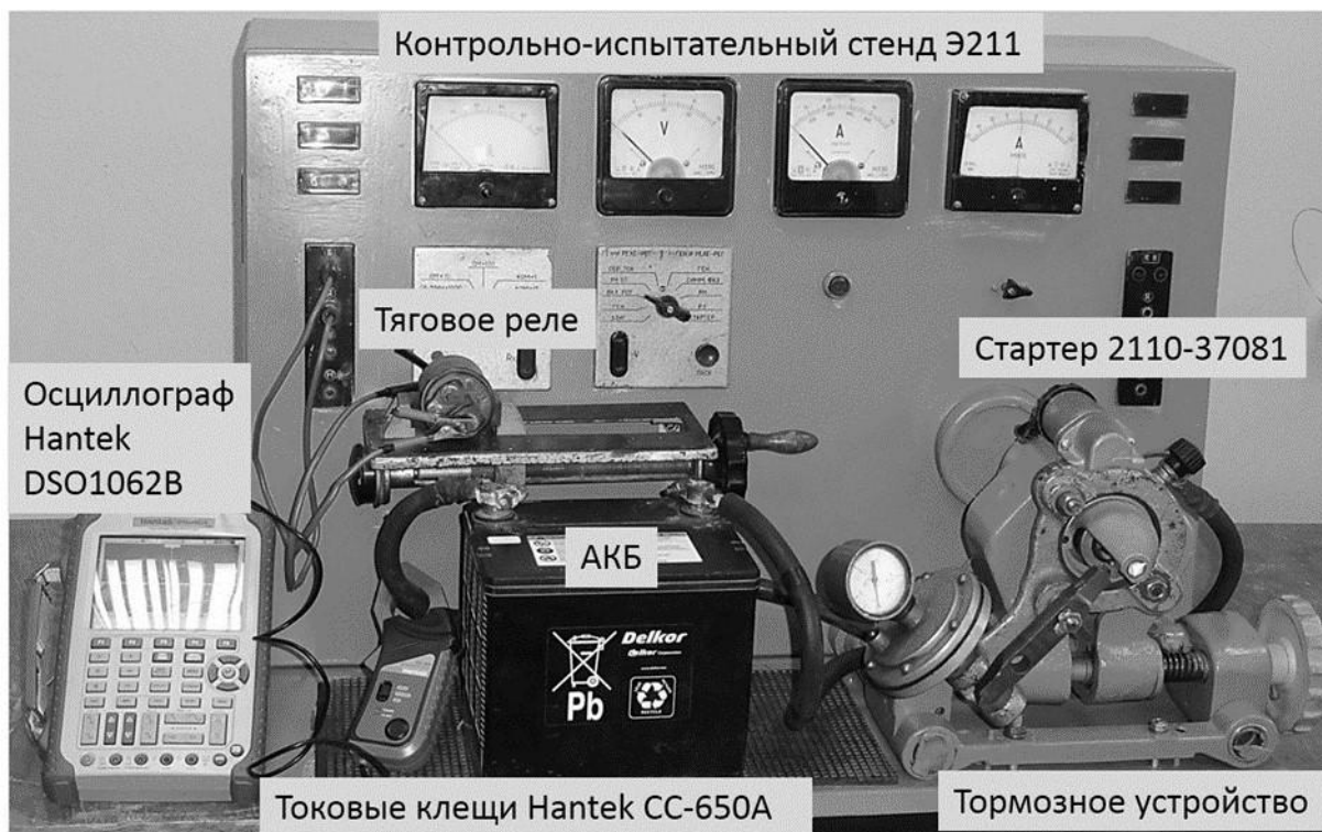
Рисунок 2 – Общий вид стенда для диагностирования автомобильных стартеров
