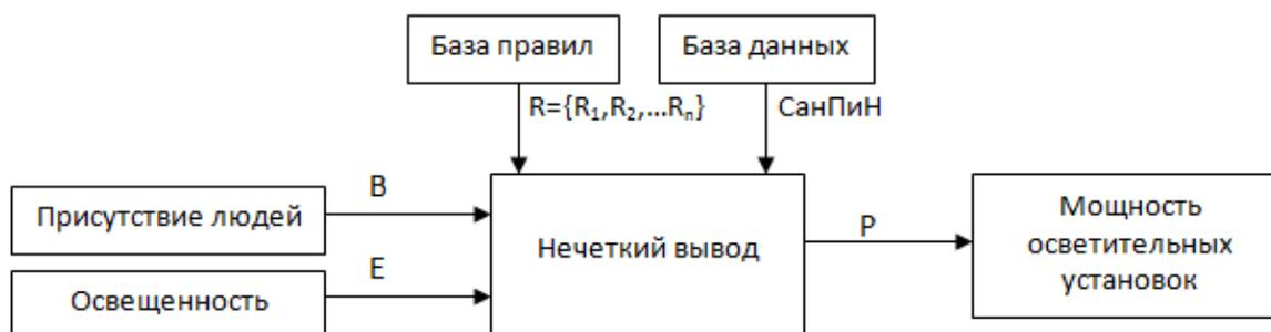
Рисунок 1 – Структурная схема АСУ осветительными установками
