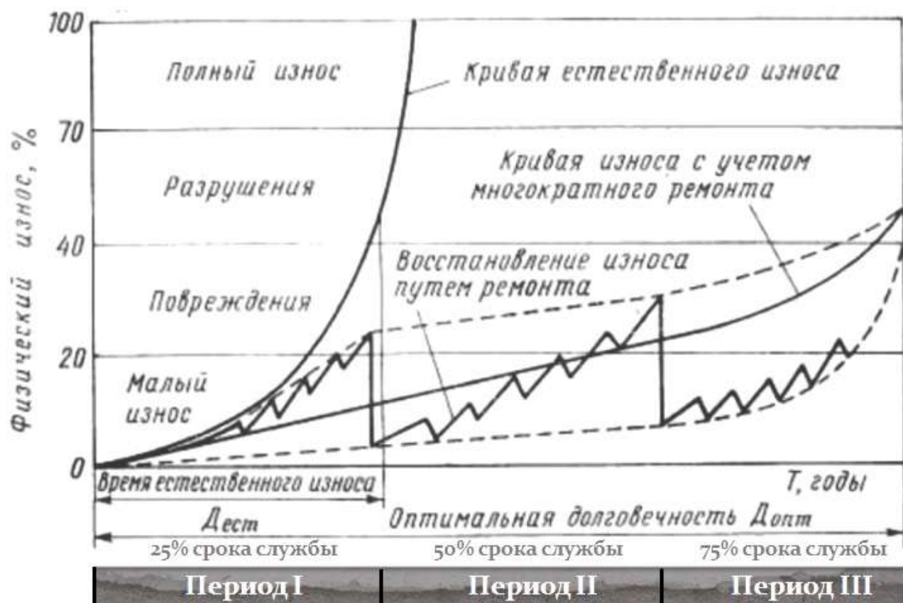
Рисунок 1 - Учет физического износа в жизненном цикле здания
