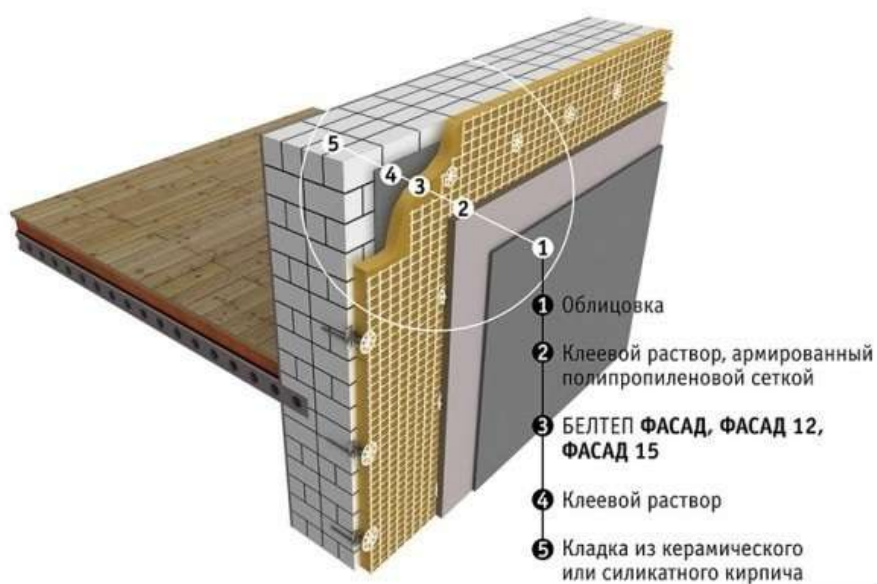
Рисунок 1 - Эскиз утепления конструкций минеральной ватой Белтеп
