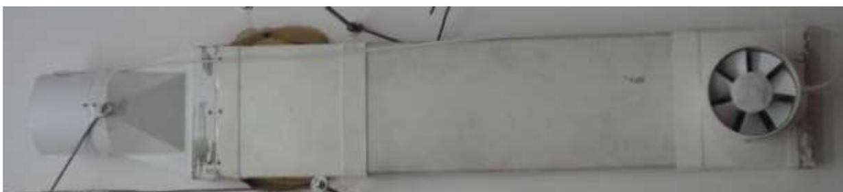
Рисунок 7 - Прототип разрабатываемой системы автономной вентиляции, установленный для проведения испытаний
