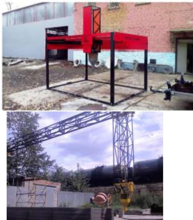
Рисунок 2 – Строительные принтеры трехмерной печати (3D) серии S, производство «Спецавиа»:
