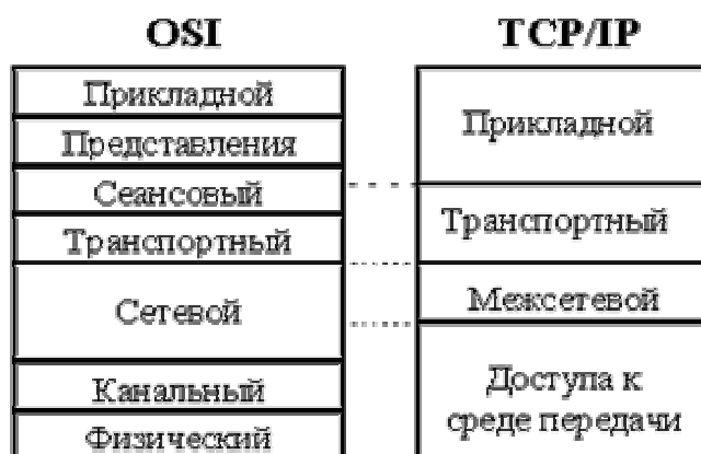
Рисунок 3 – Соответствие стека протоколов TCP/IP модели OSI
