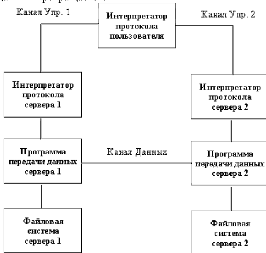
Рисунок 2 – Соединение с двумя разными серверами и передача данных между ними
