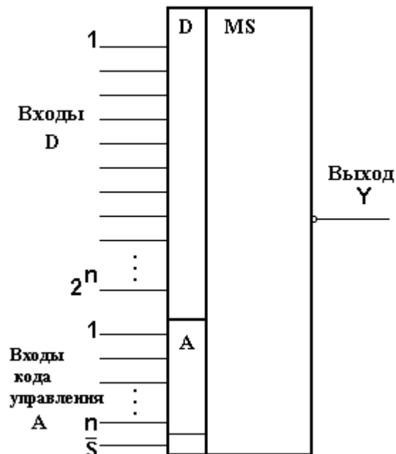
Рисунок 2.6 – Условно - графическое обозначение мультиплекса
