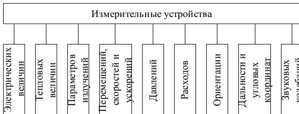
Рисунок 3.1 – Схема классификации измерительных устройств по типу измеряемых величин
