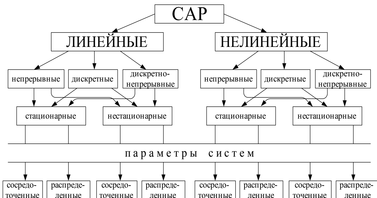
Рисунок 2.1 – Классификация систем автоматического регулирования
