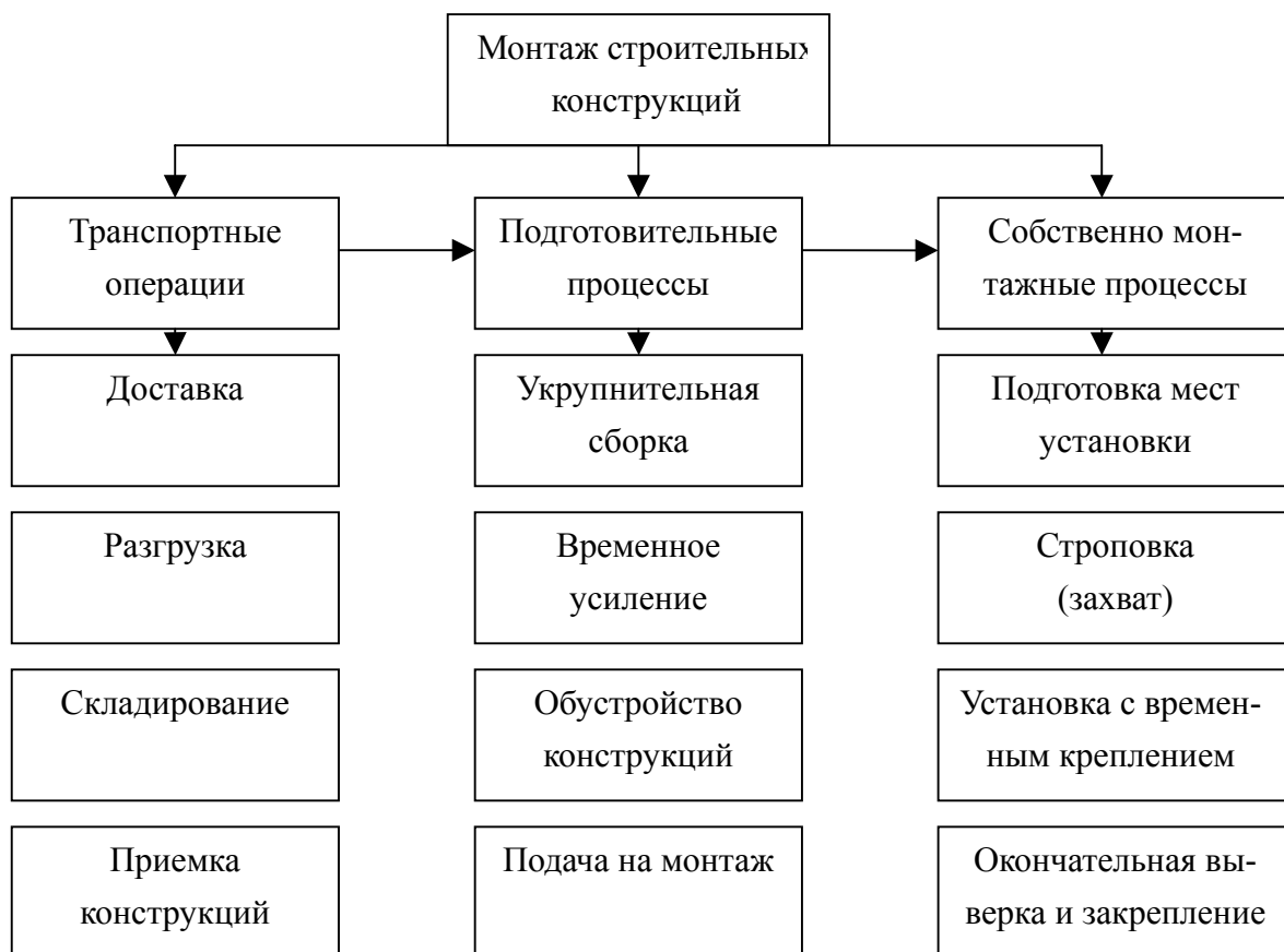
Рисунок 6 – Схема технологического процесса монтажа строительных конструкций
