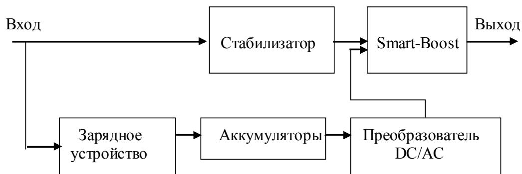
Рисунок 1.5 – Линейно-интерактивный ИБП
