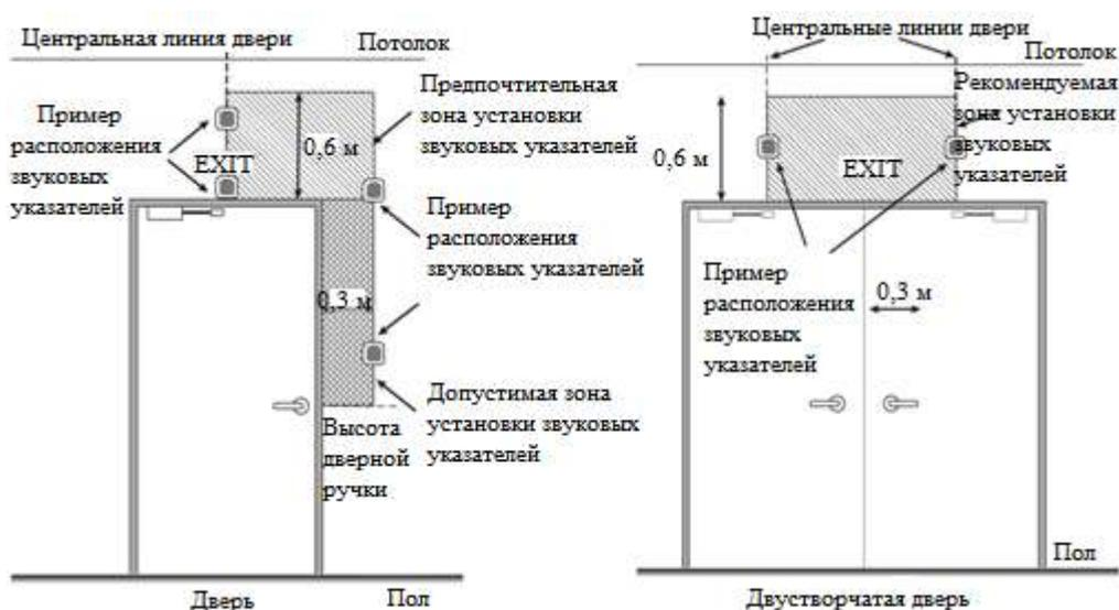
Рисунок 1 - Расположение звуковых указателей рядом с одностворчатой и двустворчатой дверью
