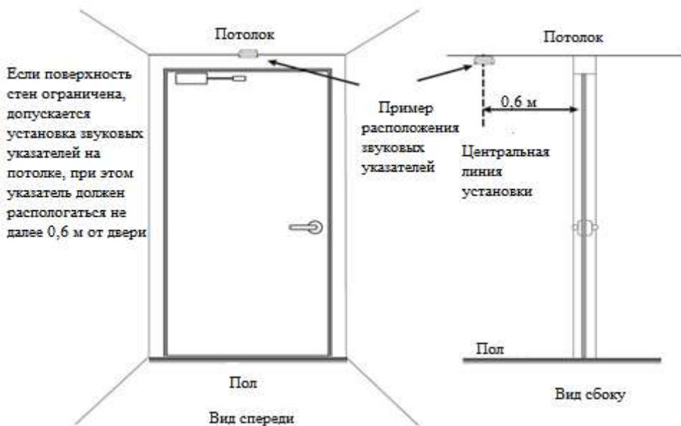
Рисунок 2 - Установка звуковых указателей на потолке
