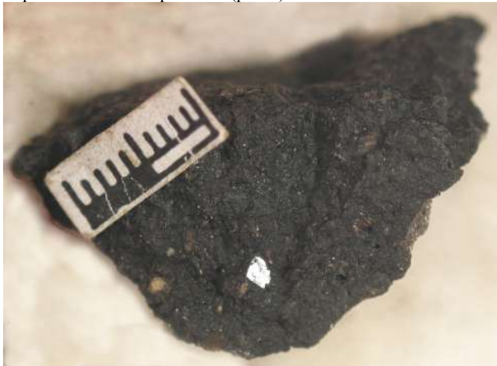
Рисунок 1 - Внешний вид асфальтита: на фоне черного битума хорошо заметен кристалл кальцита с плоскостью спайности. Линейка – 1 см
