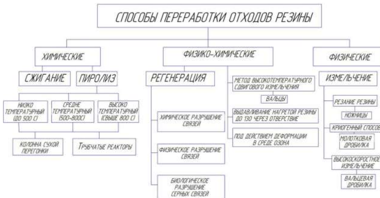
Рисунок 1 – Классификация способов переработки резиносодержащих отходов
