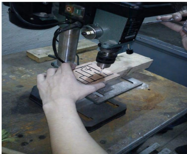
Рисунок 1 – Обработка печатной платы на сверлильном станке
