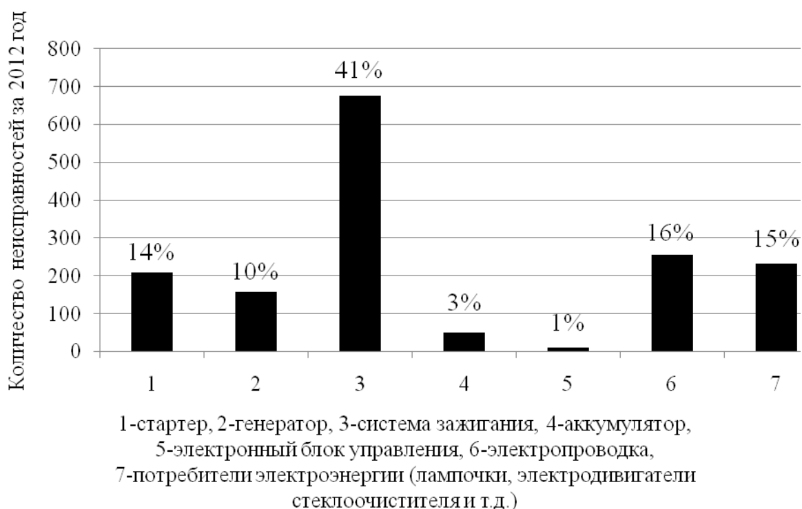
Рисунок 1 – Количество неисправностей электрооборудования ГАЗ-32214 за 2012 год.
