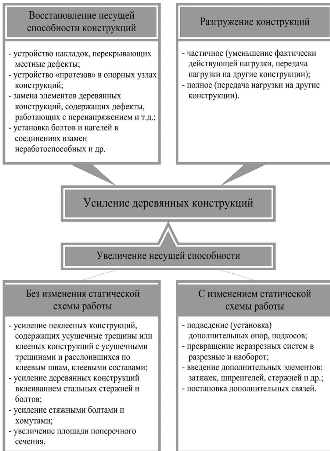
Рис. 1 Классификация способов усиления деревянных конструкций
