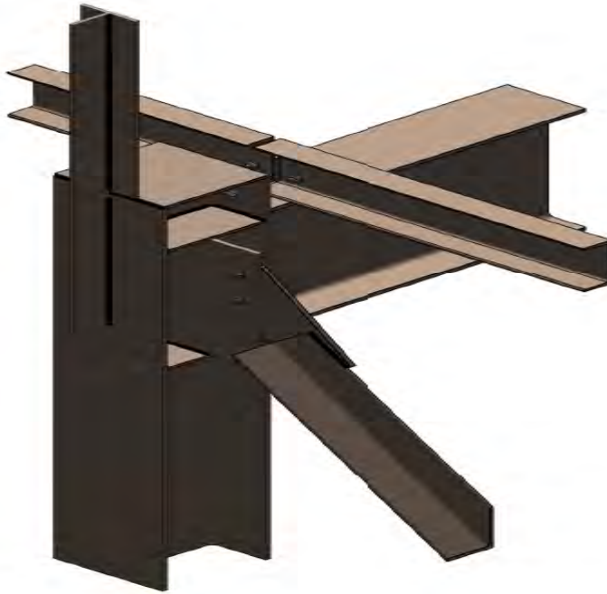
Рисунок 3 – Узловое соединение конструкций каркаса, полученный на основе 3-D модели общественного здания
