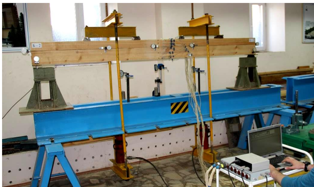
Рисунок 2 – Опытная составная балка на испытательном стенде.
