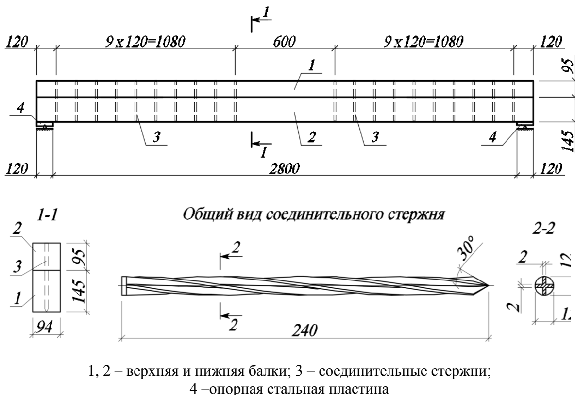
Рисунок 1 – Опытная конструкция составной балки.
