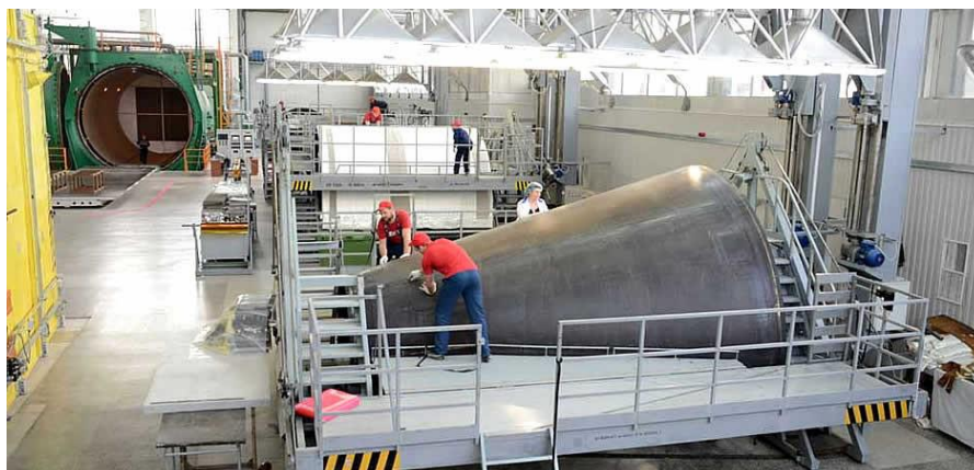
Рисунок 3 — Нанесение стекловидного покрытия на внешнюю сторону корпуса ЛА
