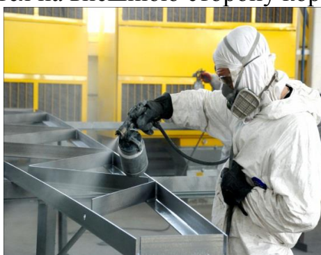
Рисунок 5 — Нанесение грунтовки на элемент ЛА
