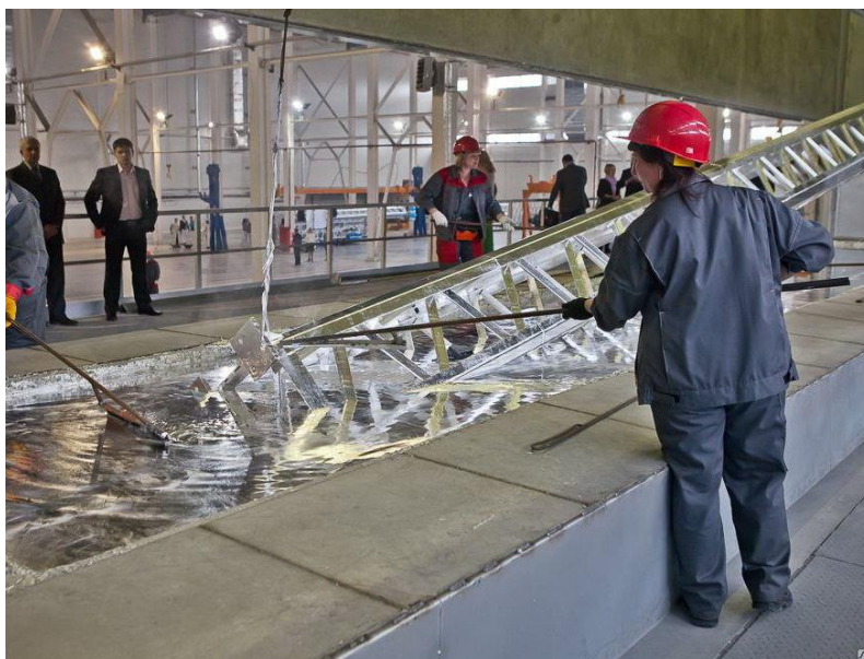
Рисунок 4 — Горячее покрытие элемента ЛА
