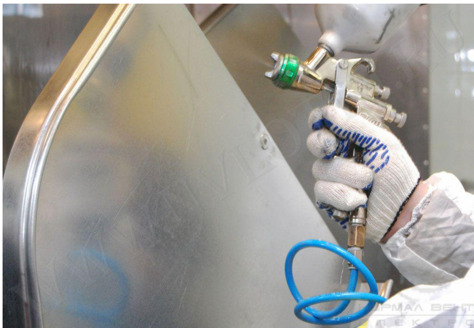
Рисунок 6 — Нанесение ингибитора на поверхность ЛА
