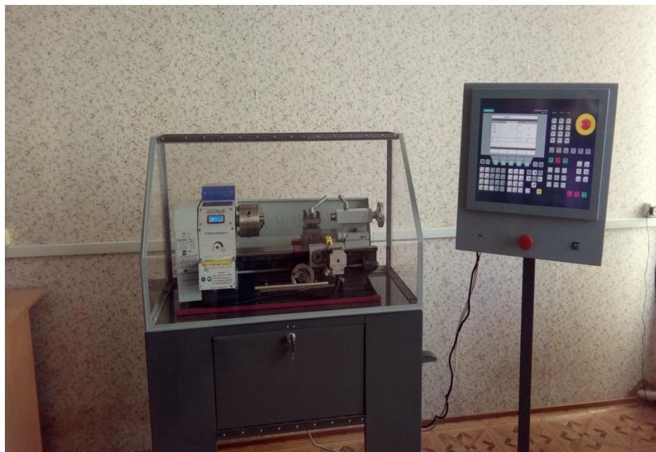
Рисунок 3 – Общий вид токарного станка с ЧПУ на подставке с защитным ограждением и пультом оператора
