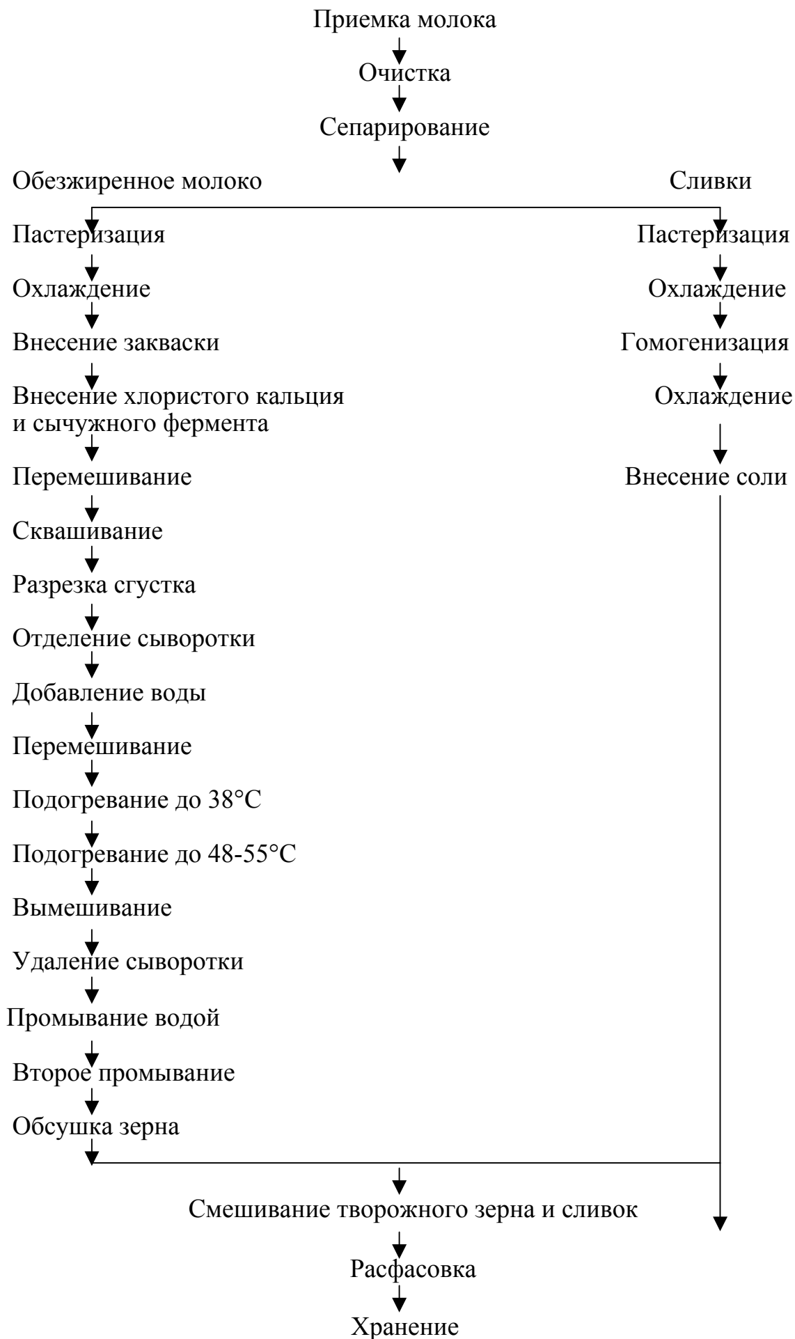
Схема 2.7 - Технологическая схема производства домашнего сыра
