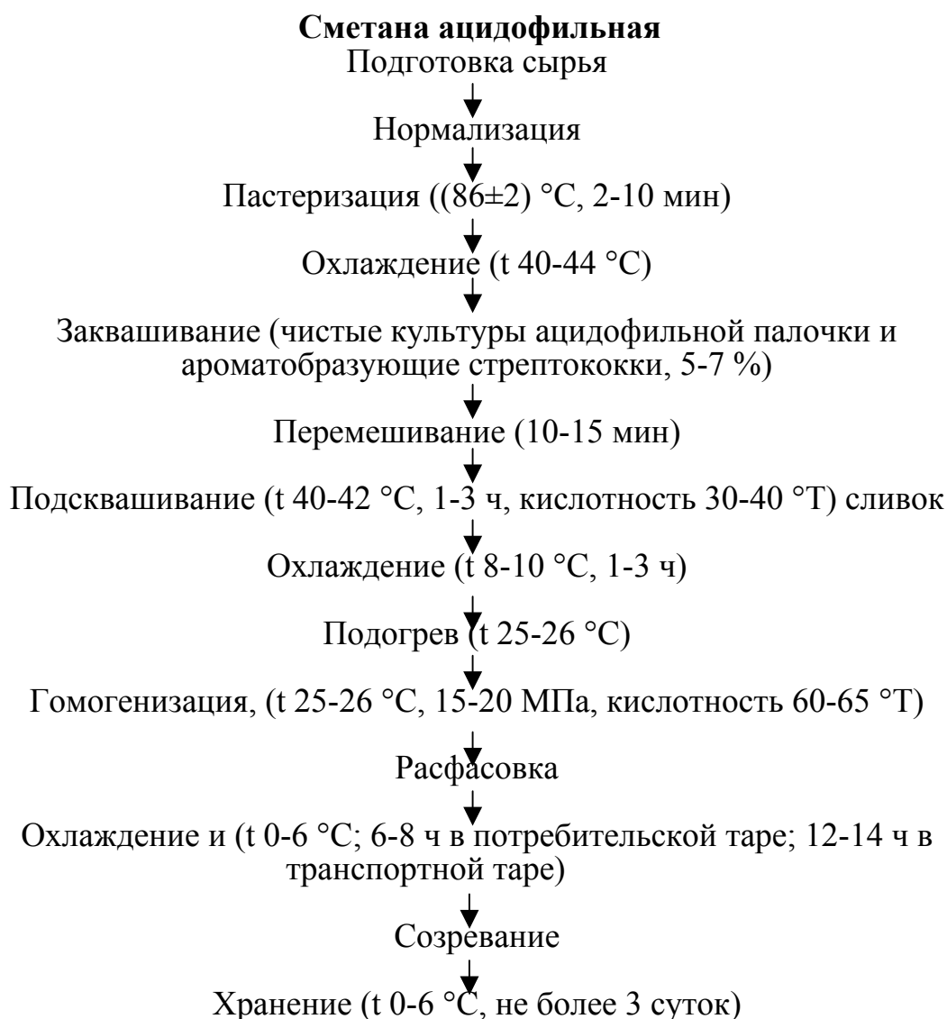
Схема 2.10 – Технологическая схема производства сметаны ацидофильной
