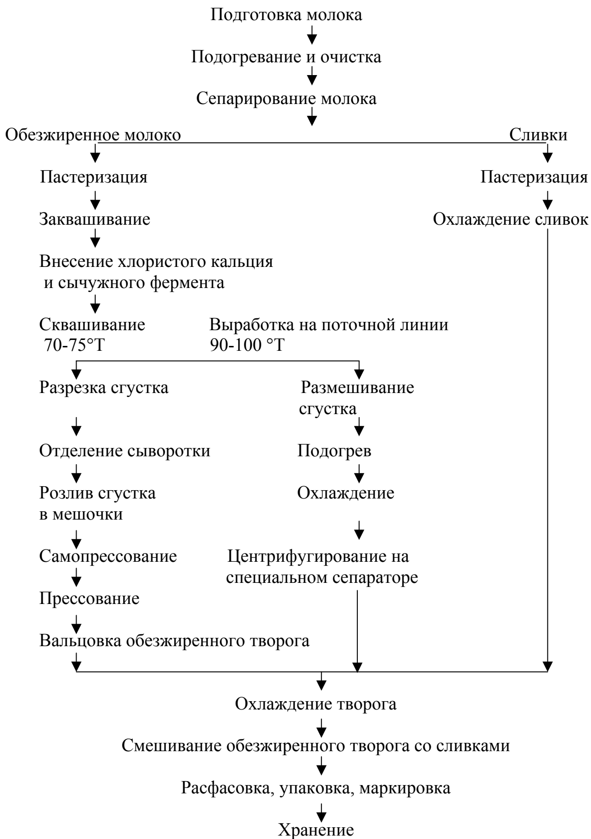
Схема 2.6 - Технологическая схема выработки творога раздельным способом
