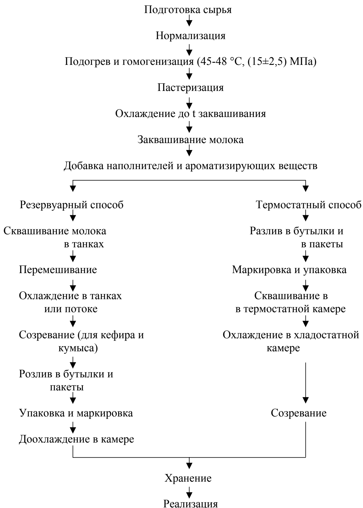
Схема 2.2 – Технологическая схема производства кисломолочных напитков
