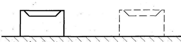
Рисунок Н.1 – Уровень, укрепленный на подставке с двумя опорами, переставляют по проверяемой поверхности так, чтобы задняя опора каждый раз устанавливалась на место передней, и отсчитывают отклонения от горизонтали. По полученным данным строят график отклонений точек профиля относительно горизонтальной плоскости, проходящей через нулевую точку, и определяют отклонения от прямой, соединяющей крайние точки профиля, и от прилегающей прямой (плоскости)
